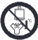
Installare lontano da eccessive fonti di calore (es. collettori di scarico).
